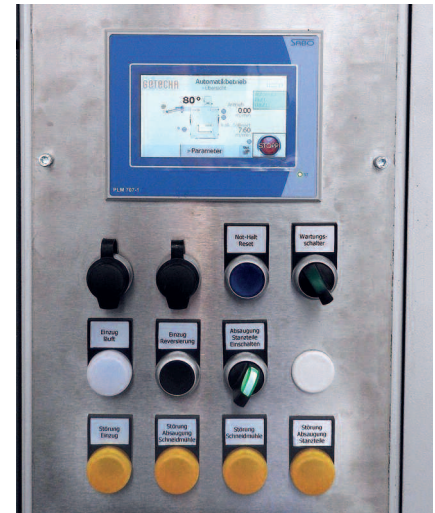
一切都一目了然: Getecha造粒机触摸屏控制面板, 以及综合的进、出料技术
